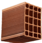
13,5LİK TUĞLA EBAT: 280 X 190 X 135 MM AĞIRLIK: 4,40 KG KULLANIM ALANI: DIŞ DUVAR SİSTEMLERİ
