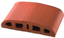
HARPUŞTA TUĞLASI EBAT: 290 X 190 X 70 MM AĞIRLIK: 4,20 KG KULLANIM ALANI: BAĞÇE DUVARI ÜSTLERİ, ÇATI PARAPETLERİ
