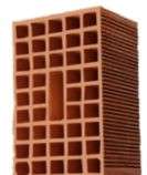
BLOK TUĞLA EBAT: 28 X 20 X 25 CM AĞIRLIK: 6,40 KG KULLANIM ALANI: DIŞ DUVAR SİSTEMLERİ
