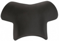
BETON ÜÇYOL MAHYA EBAT: 400 X 390 X 120 MM AĞIRLIK: 6,00 KG KULLANIM ALANI: ÇATI SİSTEMLERİ
