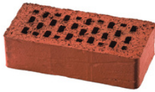
ALMAN TUĞLASI EBAT: 240 X 115 X 50 MM AĞIRLIK: 2,15 KG KULLANIM ALANI: CEPHE KAPLAMALARI, RESTORASYON
